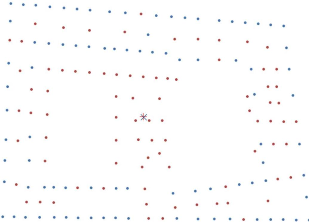
Disposizione in pianta dei dispositivi elastomerici e delle slitte, con indicazione del baricentro delle masse e delle rigidezze del sistema di isolamento
