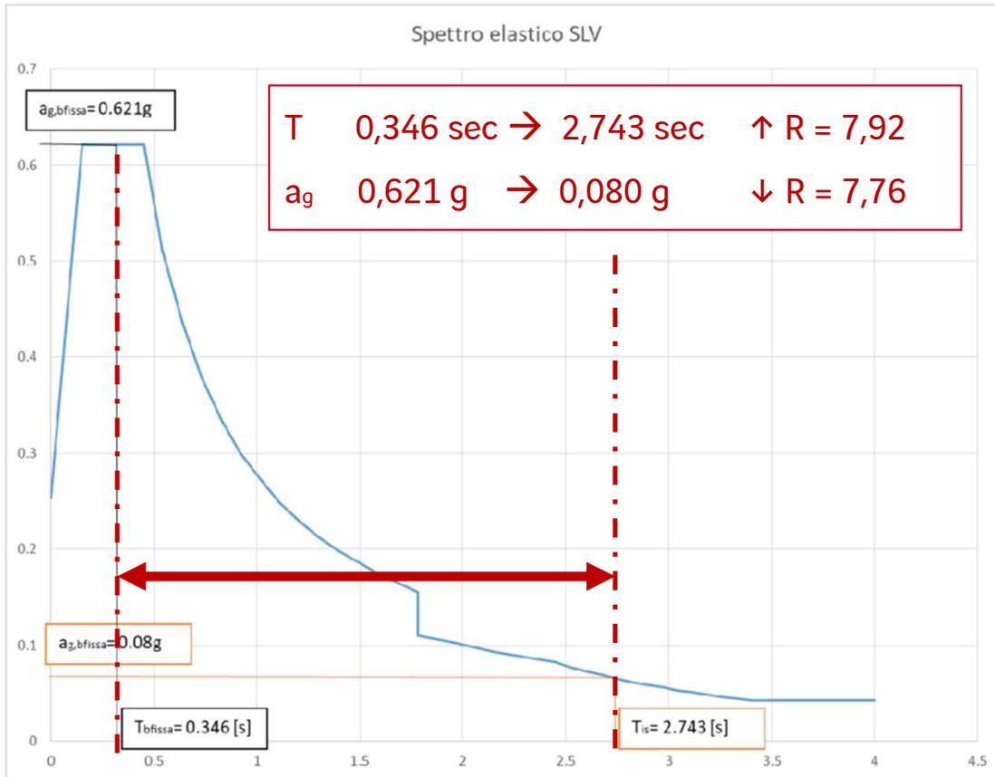
Sintesi dei risultati: Indicatori di Rischio sismico  $\zeta_E$  in termini di PGA
