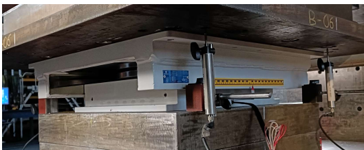
Appoggio strumentato durante il processo di calibrazione
