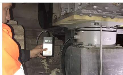
Monitoraggio in situ del carico verticale di un CD TETRON® iniettabile
