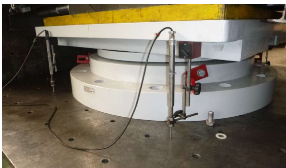
Test su appoggio unidirezionale TETRON® CD presso la struttura di prova ISOLAB Ponte all'incrocio di Prince Turki Rd. con King Abdullah Rd. (Arabia Saudita)
