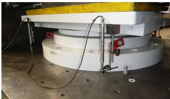
Test su appoggio unidirezionale TETRON® CD presso la struttura di prova ISOLAB
