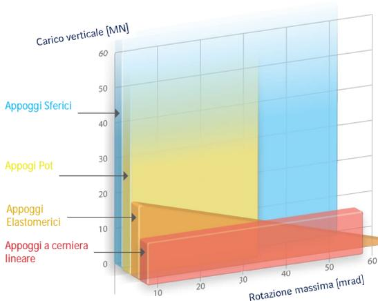
Capacità degli appoggi Pot rispetto ad altri tipi di appoggi
