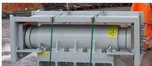
Esempio di dima di installazione
