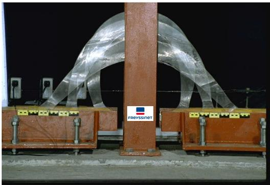
Immagine multi-frame del test di ISOSISM® DDD
