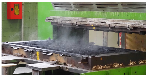
Giunto Multiflex all'apertura della pressa di vulcanizzazione
